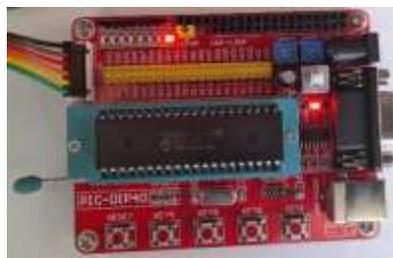
Figura 8: Controlador com PIC 16F877A
