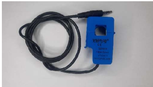
Figura 7 - Transformador de corrente 100A:50mA – modelo SCTO13. Fonte: Autor (2022).
