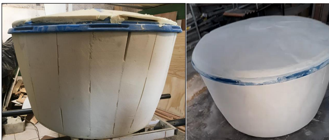
Figura 27 - CX1 isolada com poliuretano.
