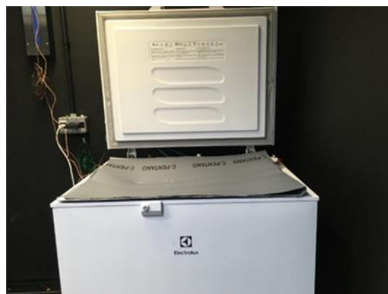
Figura 18 - Ensaio utilizando um tapume de poliuretano.
