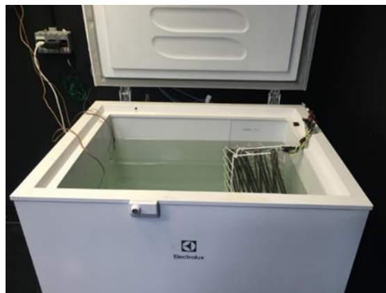
Figura 17 - Teste de aquecimento com a porta aberta.
