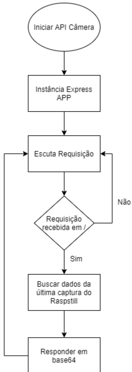
Figura 30: Fluxograma do uso da câmera.
