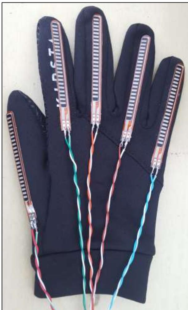
**Figura 18 – Luva Kipsta® Keepwarm com sensores flexíveis**
