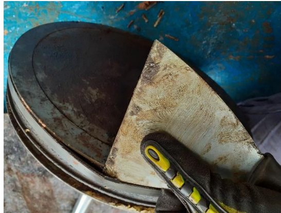
Figura 2 – Troca de kits de reparo dos cilindros
