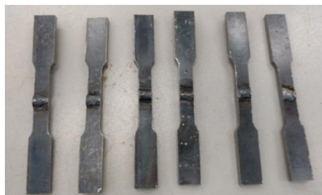
Figura 11 - Corpos de prova soldados, prontos para ensaio de tração.
