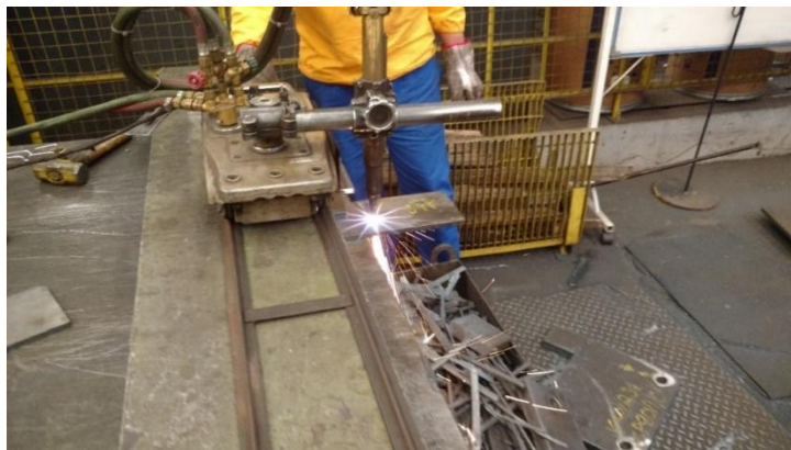
Figura 3 - Corte dos corpos de prova utilizados no experimento.
