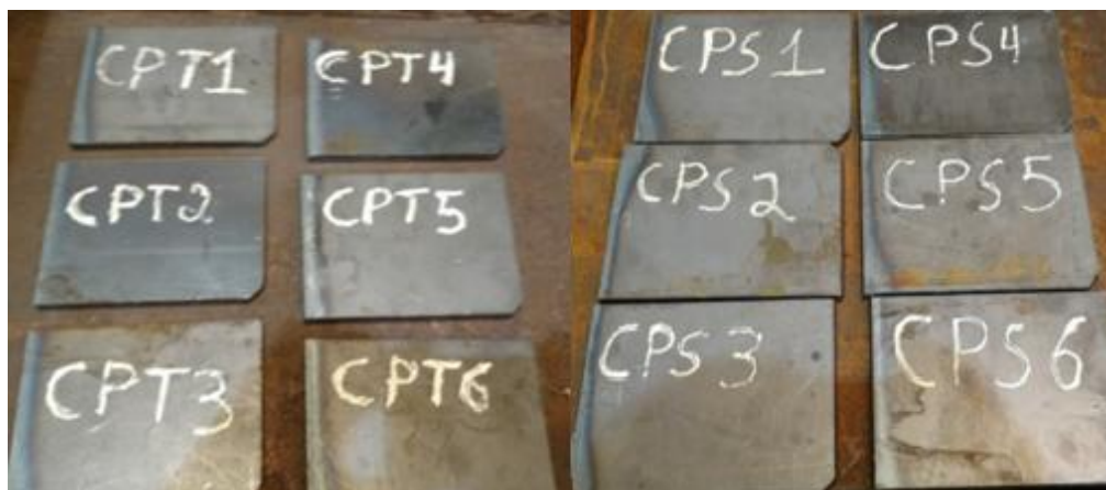
Figura 4 - Chapas que serão soldadas com arame tubular (CPT) e arame sólido (CPS).
