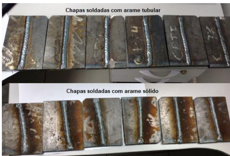
Figura 7 - Chapas soldadas com arame tubular e sólido.
