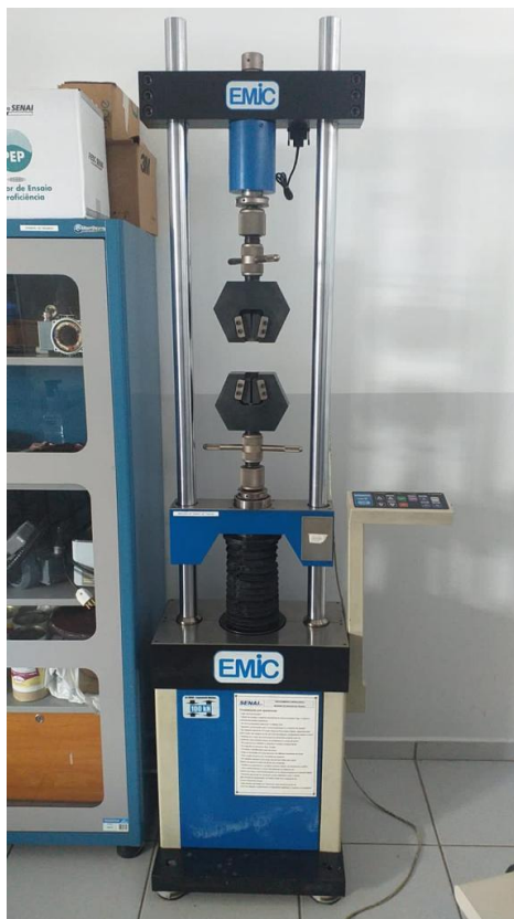
Figura 6 - Equipamento utilizado para realização do ensaio de tração dos corpos de prova.
