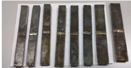
Figura 10 - Corpos de prova soldados e cortados, pronto para usinagem.
