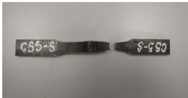
Figura 15 - Local de ruptura de um corpo de prova soldado pelo processo GMAW, que não apresentou falhas.
