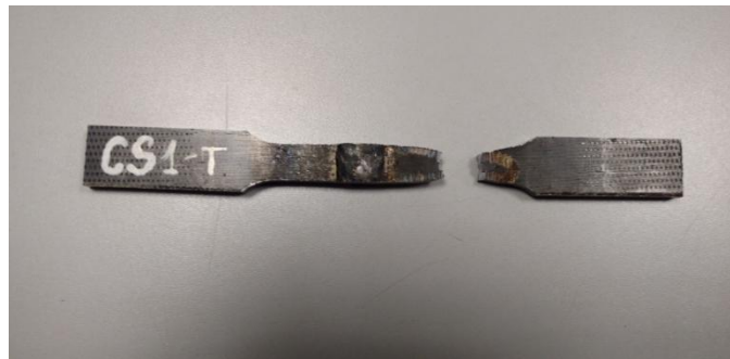
Figura 14 - Local de ruptura de um corpo de prova soldado pelo processo FCAW.
