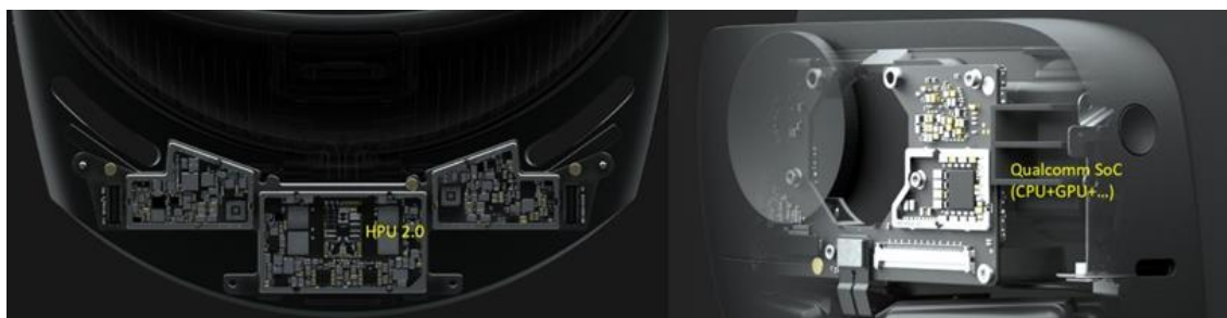
Figura 16 – A HPU (topo) está localizada na frente do dispositivo, perto dos sensores. O SoC (em baixo), um Qualcomm Snapdragon 850
