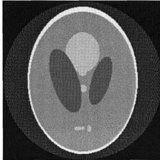
Figura 30 - Imagem reconstruída com redes a partir de 256 pontos e 90 projeções, utilizando 60 coeficientes de filtro.
