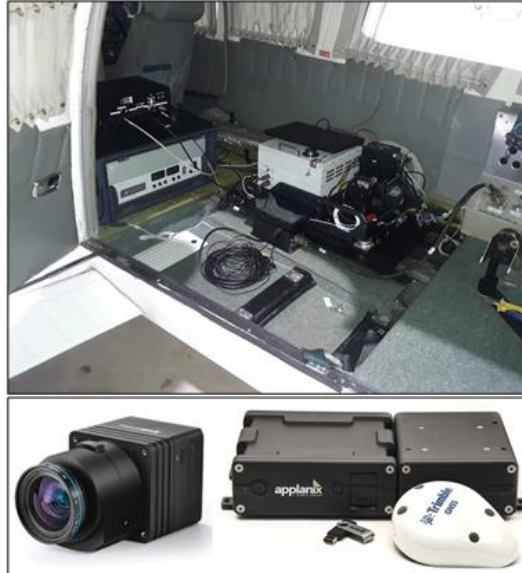
Figura 2: Conjunto modulado pela Trimble, com Câmera Digital IXU-RS-1000, plataforma e Sistema GPS/IMU AP50. Fonte: Relatório de Levantamento Aerofotogramétrico e Perfilamento Laser (2019)
