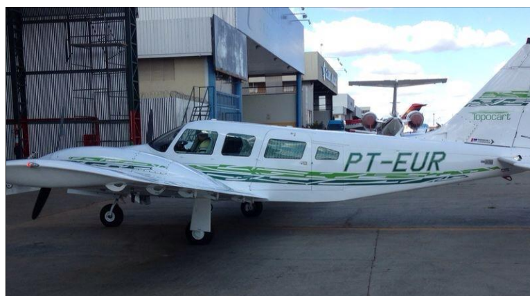
Figura 1: Aeronave Sêneca II prefixo PT-EUR, utilizada no Levantamento Aerofotogramétrico. Fonte: Relatório de Levantamento Aerofotogramétrico e Perfilamento Laser (2019).
