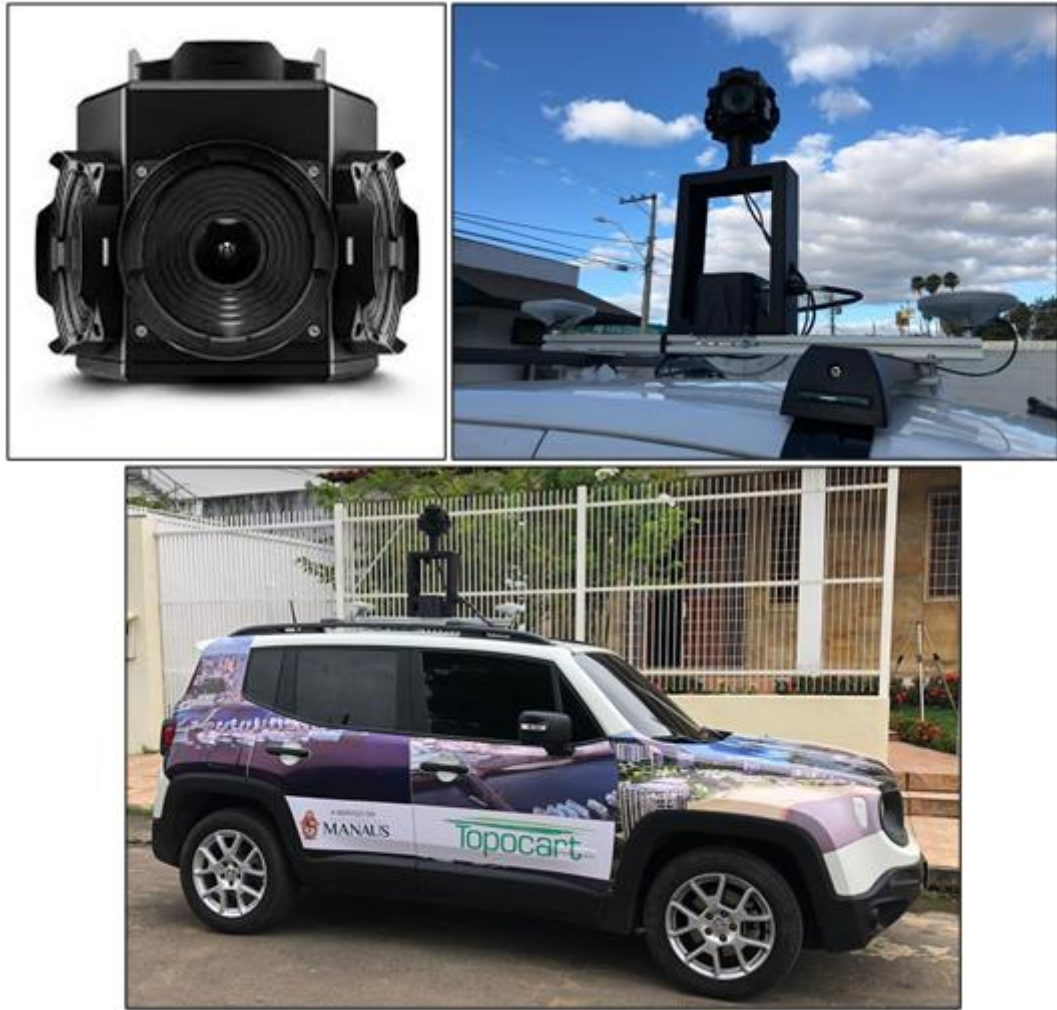
Figura 8: Câmeras Fotogramétricas Ladybug 5+ acoplada no Jeep Renegade, utilizado na coleta do Mapeamento Móvel Terrestre. Fonte: Relatório do Mapeamento Móvel Terrestre 360° (2020)
