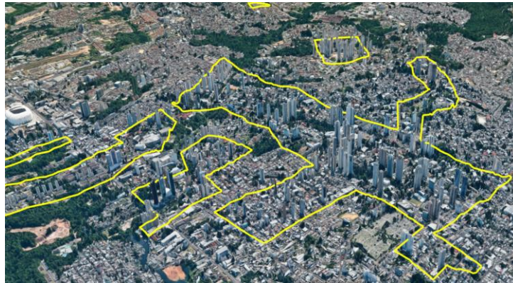
Figura 4: Levantamento de áreas contínuas com incidência de edifícios de grande porte para realização de faixas extras de voo. Fonte: Relatório de Levantamento Aerofotogramétrico e Perfilamento Laser (2019)
