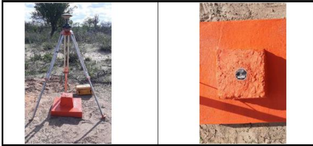
Figura 6: Marco geodésico sendo rastreado por aparelho GPS para aquisição de coordenadas de referência. Fonte: Relatório de Levantamento Aerofotogramétrico e Perfilamento Laser (2019)
