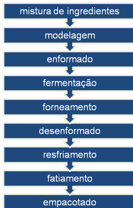
Figura 1- Processo de fabricação de pão de forma simplificado (massa direta) - OBS: em alguns processos industriais pode existir uma segunda instancia de fermentação entre a mistura de ingredientes e a modelagem, ou ainda duas etapas de modelagem e duas de fermentação intercaladas, antes do forneamento. Fonte: o autor.
