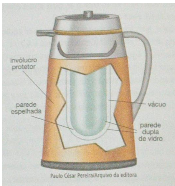
Figura 05: Esquema de uma garrafa térmica caseira/comum
